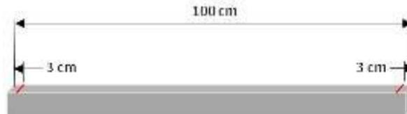
11. Lakukan pemotongan menggunakan gunting diketiga sisi hollow sepanjang 3cm dengan posisi pemotongan sama dikanan dan kiri ujung hollow.
