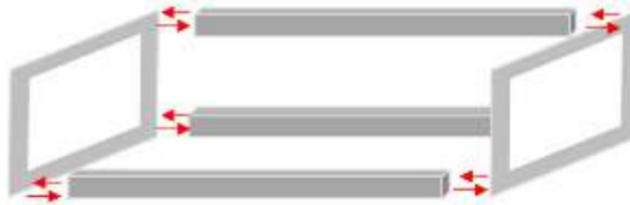
13. Lakukan pemasangan papan kayu pada bagian bawah rak menggunakan bor dan pengunci rifet.
