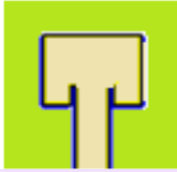
Gbr 3. Desain Antena Mikrostrip Patch Double Layer Berfrekuensi 2,4 Ghz
