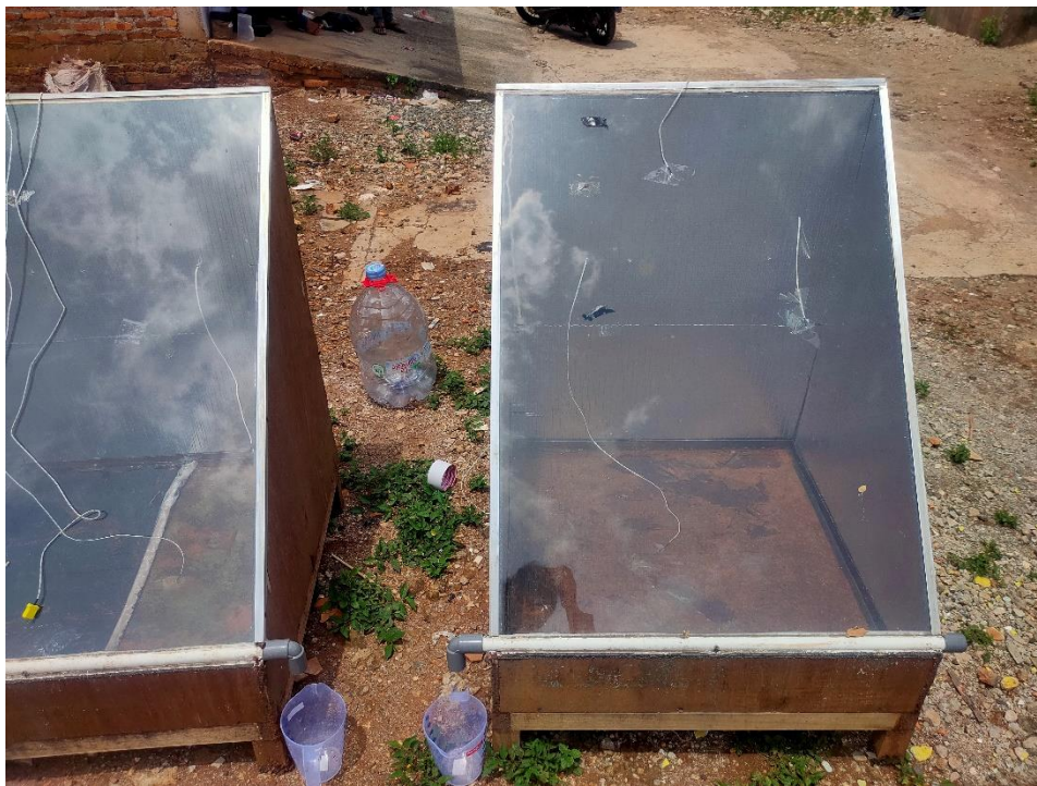
Lampiran 4.6 Distilasi Air Laut Tenaga Surya Tipe Kolektor Plat Datar Tanpa Absorber
