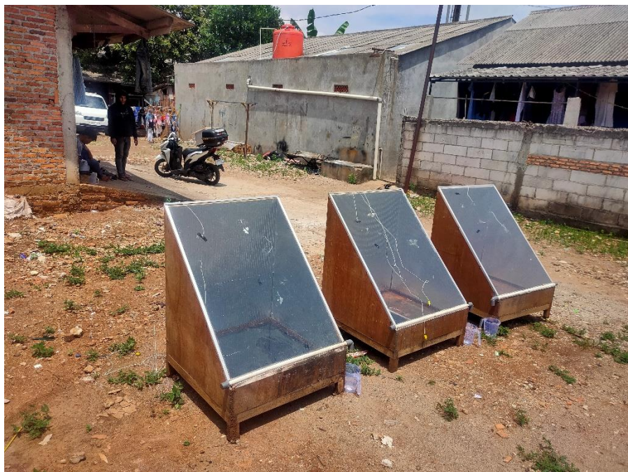
Lampiran 4. 2 Tampak Samping Dari Alat Distilasi Yang Dibuat Pada Saat Pengujian
