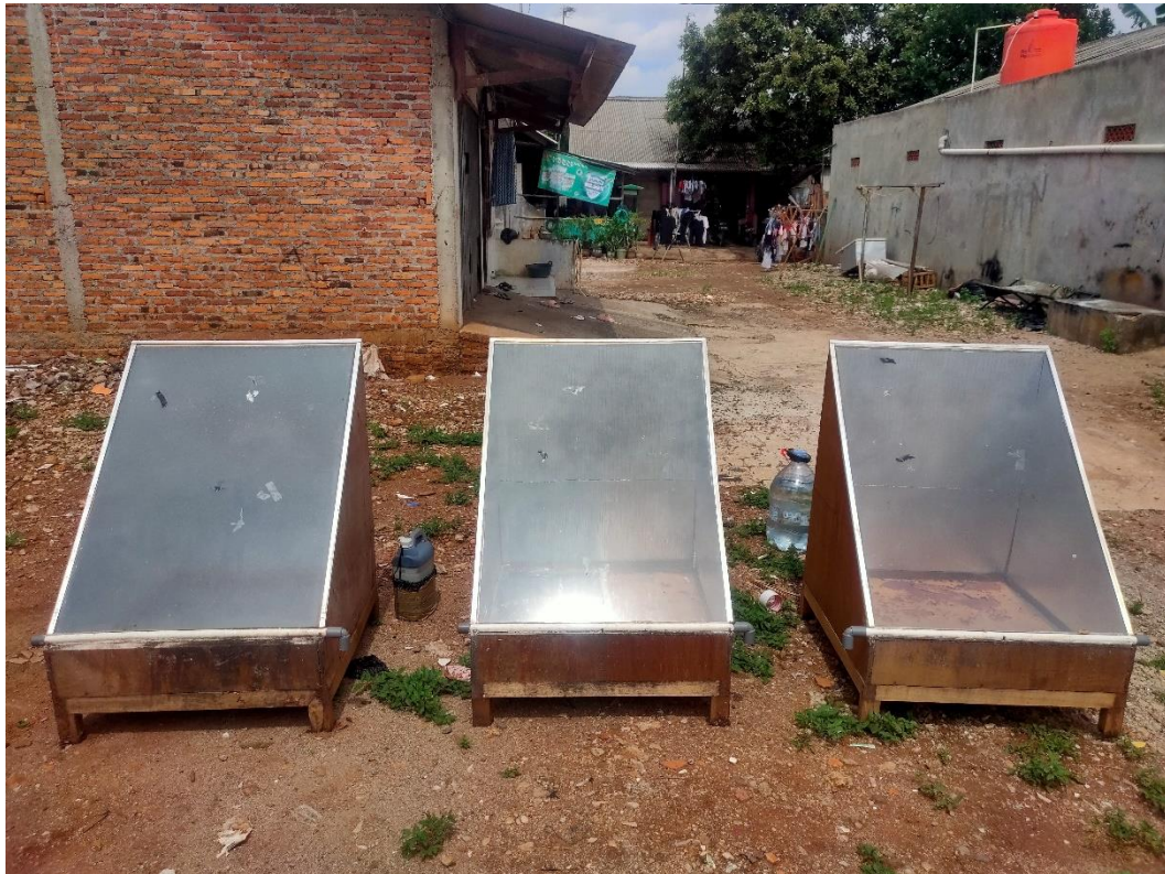
Lampiran 4. 1 Tampak Depan Dari Alat Distilasi yang Dibuat Pada Saat Pengujian
