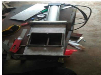
Gambar 4.6 Proses Perakitan Mesin Pemetong Kentang
