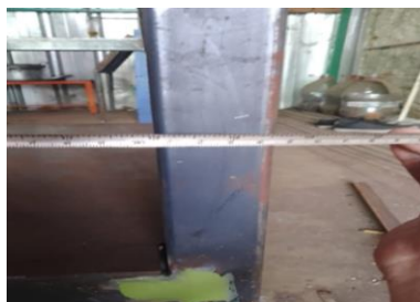
Gambar 4.2 Proses Pengukuran material Mesin Pemotong Kentang
