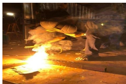
Gambar 4.4 Proses Pengelasan Rangka mesin Pemotong Kentang
