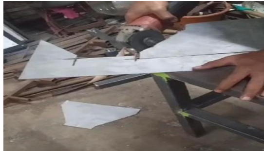
Gambar 4.3 Proses Pemotongan Material Mesin Pemotong Kentang
